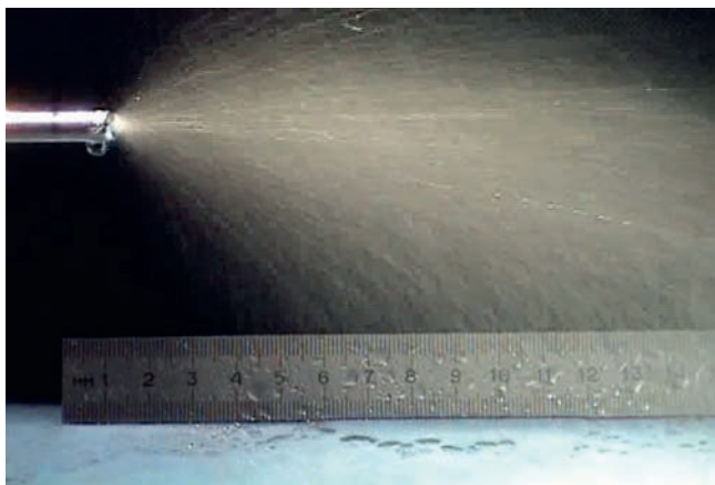
Рис. 2. Воздействие без передачи ультразвуковых колебаний (бесконтактное)
